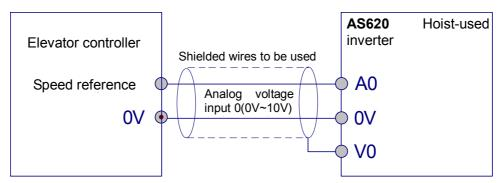
Fig- 4.19 AIO wiring
